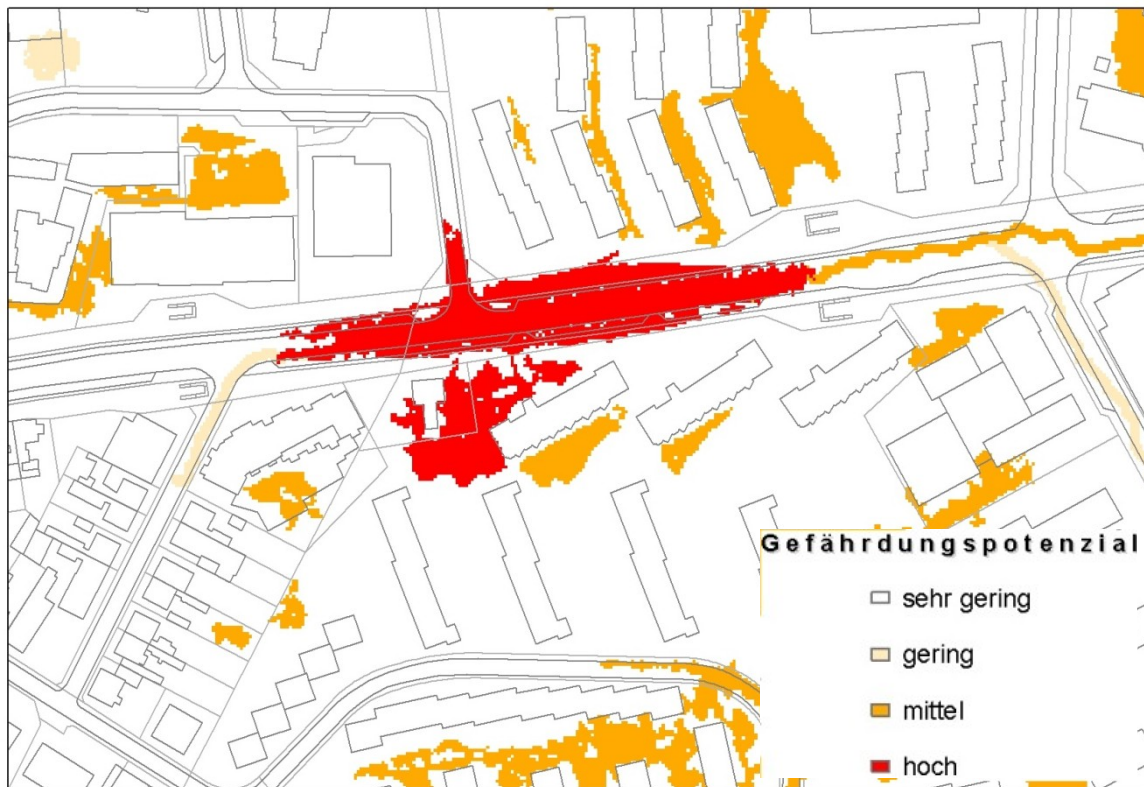
Abbildung 5.22: GPM-Karte, vier Gefährdungspotentialstufen am Beispiel der Möllner Landstraße in Hamburg, Quelle: HW
