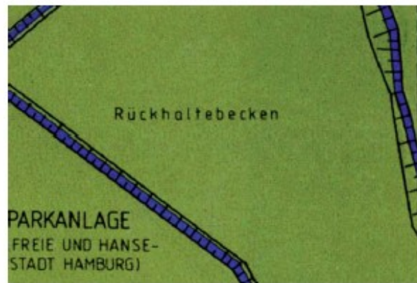
Abb. 06 Nachrichtliche Übernahme eines wasserrechtlich festgestellten Rückhaltebeckens
