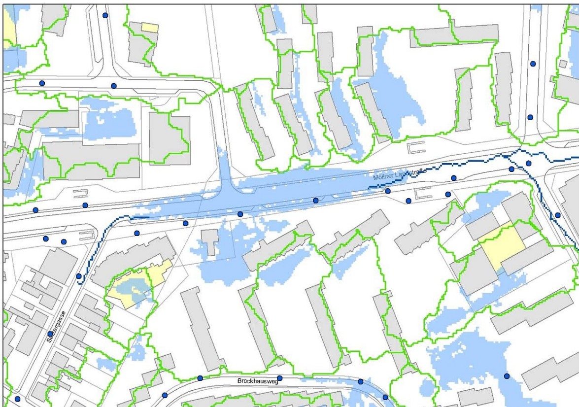
Abbildung 5.21: Fließweg- und Senkenanalyse am Beispiel der Möllner Landstraße in Hamburg, Quelle: HW
